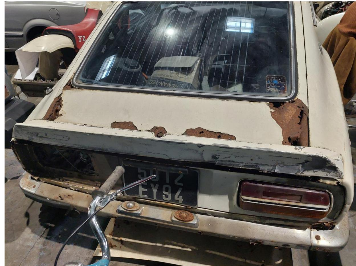
2 beaux exemples de corrosion perforante :
